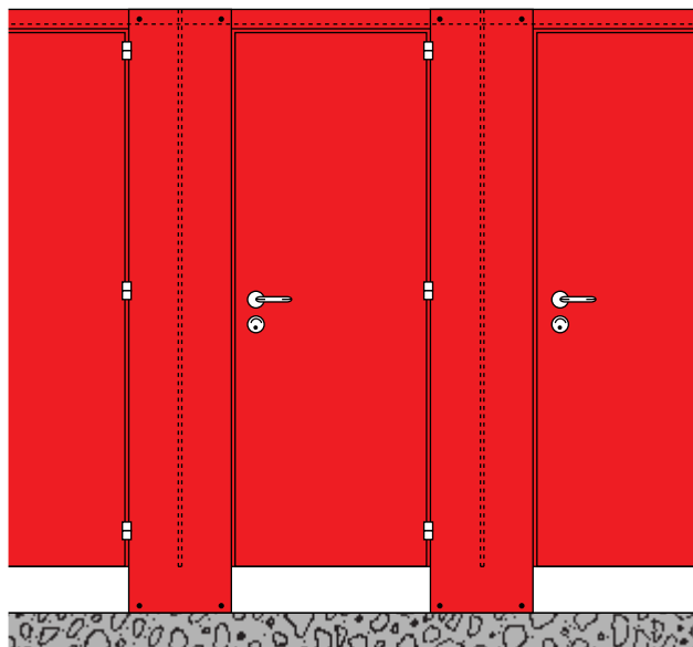
Ścianka frontowa od powierzchni posadzki
