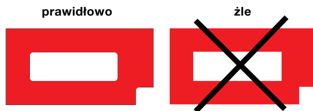
Wycięcia w płycie FunderMax Compact
