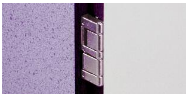
Zawias obiektowy (firma Prämeta) do drzwiczek z płyt Compact Rys. 155 Grubość drzwiczek 10 - 13 mm. Otwieranie jednoosiowe.
